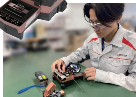
最新型光ファイバ融着接続機S001M4を動作確認中
