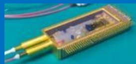
高速変調器 モジュール
