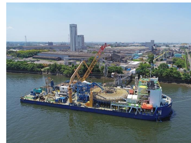
海底ケーブルの船積みの様子
