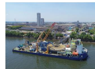
海底ケーブルの船積みの様子
