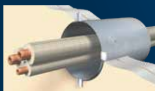
1 スリーブの設置。
