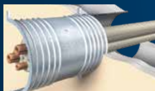
1 スリーブの設置。
