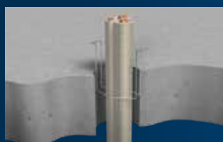
1 支え金具の設置。
