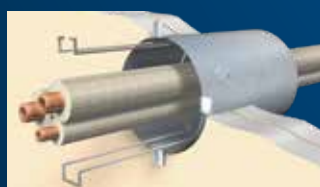
2 支え金具の設置。
