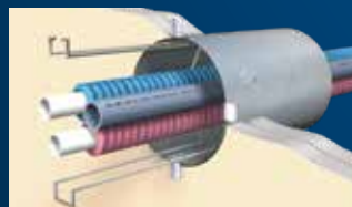
2 支え金具の設置。
