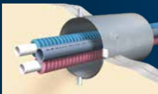
1 スリーブの設置。
