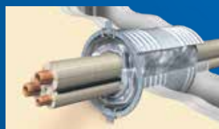
4 押さえ金具を設置して 施工完了。
