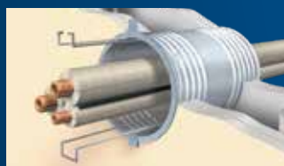
2 支え金具の設置。
