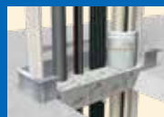
RC・ALC床 (鋼製スリーブあり)
