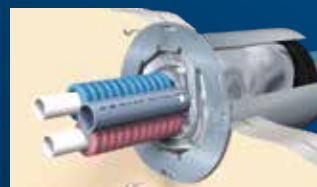
6 押さえプレートを設置して施工完了。
