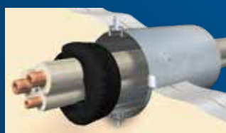
3 バックアップ材の設置。
