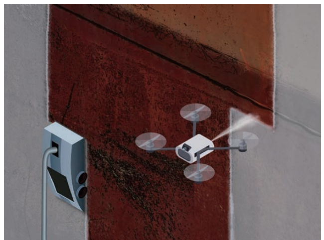
図12 将来的な船舶外板修繕向け「インフラレーザ」システムの開発イメージ Image of future development of the “InfraLaser system” for ship’s hull plate repair.
