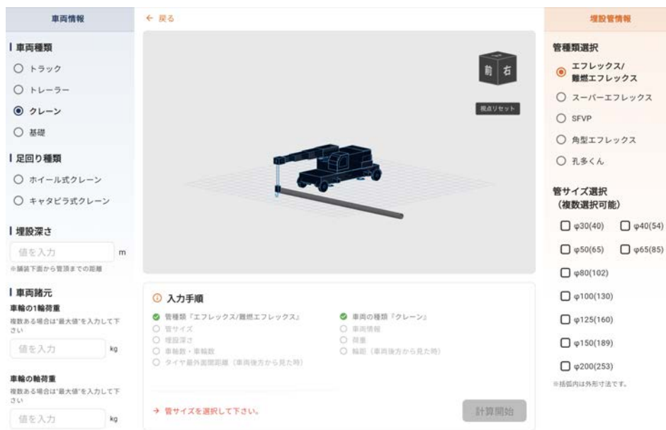
図4: クレーン選択時 — ホイール式/キャタピラ式を選択可能
