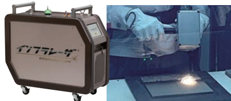
通过 Infralaser® 进行除锈和去除涂膜
