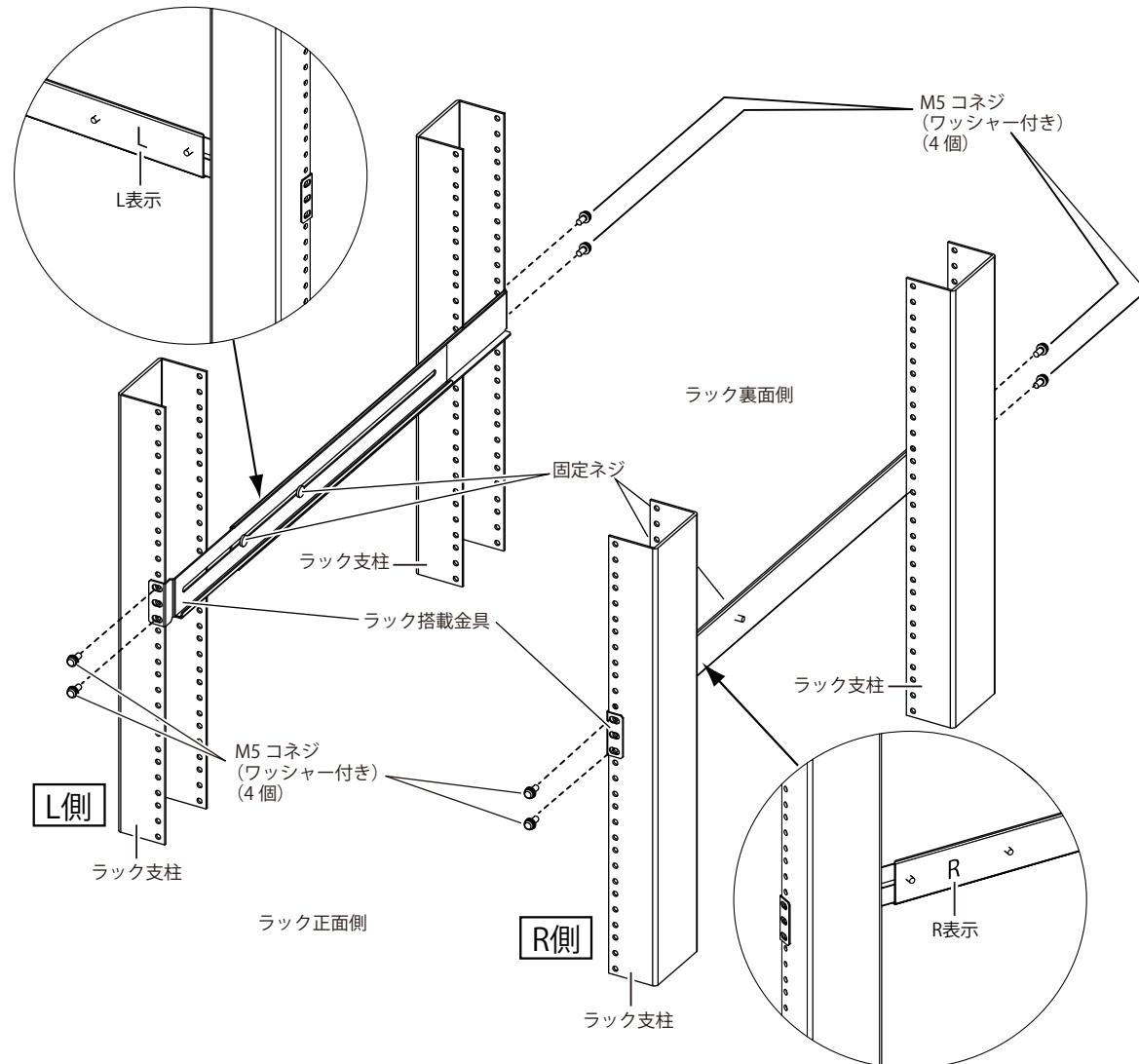
5. 本装置をラック支柱に取り付けたラック搭載金具に挿しこむように入れ、プラスドライバーを使って、装置固定金具前面のつまみネジ（ネジサイズM5）で固定します。
