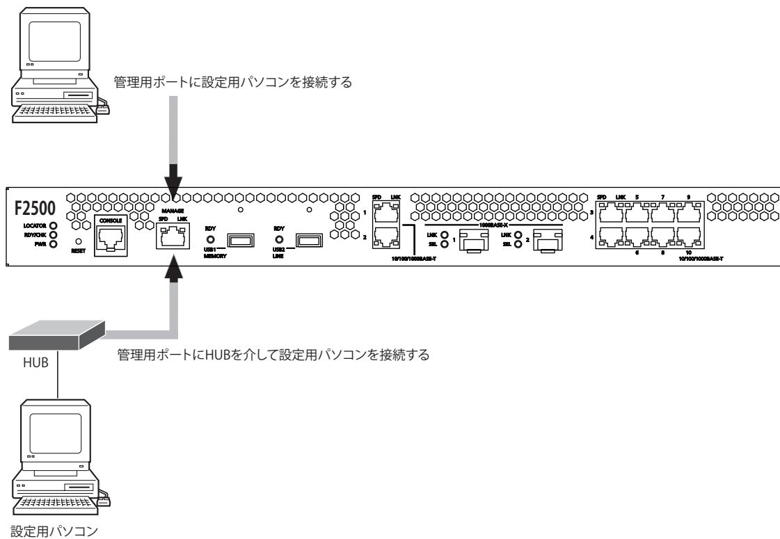
設定用パソコンと本装置をLANケーブル（ストレート）で直接つなぐ手順を説明します。
