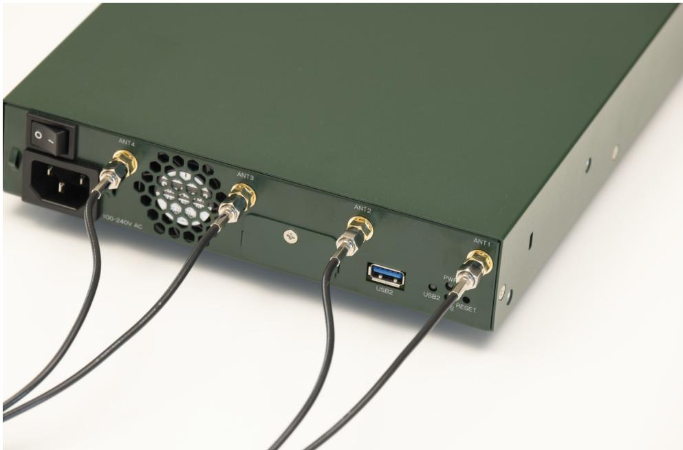
3. 適宜ラックや壁に固定してください。ネジ締めのトルク値は4N・m以下としてください。
