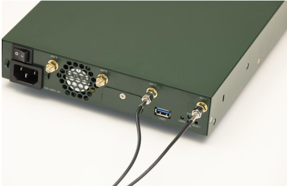
2. 同様に2個目のアンテナの延長ケーブル2本を、本装置のアンテナ端子（ANT3, ANT4）に接続します。
