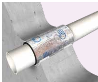
RC-ALC壁 KK2025-003号 中空壁 KK2025-004号 RC-ALC床 KK2025-002号 ※壁はシリコーンシーリング材(JIS A 5758)、床はセメントモルタルで開口部を埋め戻してください。 ※充てん厚さはRC-ALC・中空壁の場合、壁面両側から22mm以上になります。
