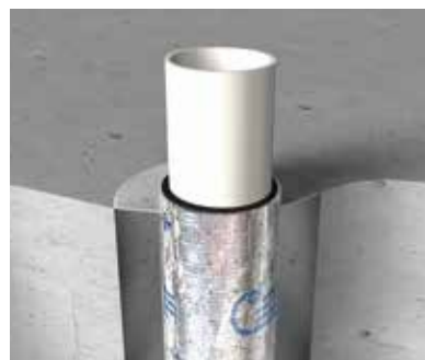
RC-ALC壁 KK2025-003号 中空壁 KK2025-004号 RC-ALC床 KK2025-002号 ※壁はシリコーンシーリング材(JIS A 5758)、床はセメントモルタルで開口部を埋め戻してください。 ※充てん厚さはRC-ALC・中空壁の場合、壁面両側から22mm以上になります。
