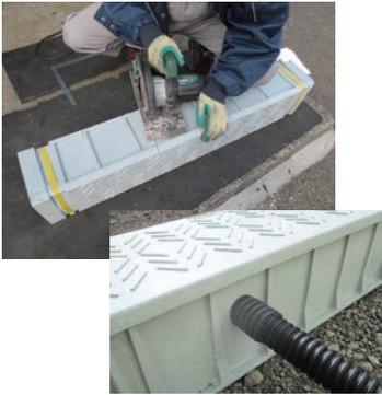
丸のこ、手のこによる切断、ホールソーによる孔開けなど、現場加工が容易。さまざまな対応が可能。
