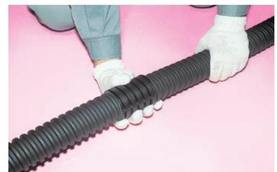
③ エフレックスの突き合わせが中央に来るようにアクアフィットを逆方向にねじ戻して接続施工完了です。
