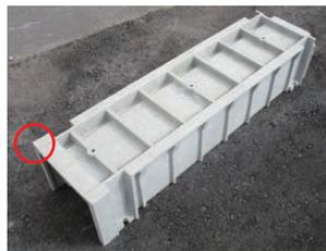
0.7mの自由落下で大きな欠損なし。(弊社実験による。)
