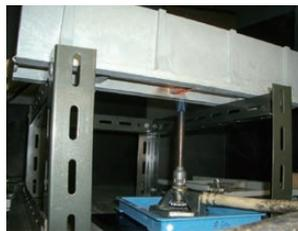
地中電線を収める管またはトラフの「自消性のある難燃性」試験方法：日本電気技術規格委員会規格 JESC E7003 (2005)「2.技術的規定」に適合。
