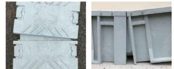
オスメス嵌合の連結式構造でモルタル処理不要。首振り機能によりレベル合わせが容易。連結部の曲げ機能により障害物回避や不陸追従が可能です。
