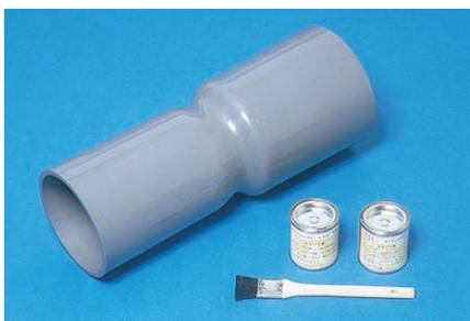
エポキシ系の接着剤を使用することによりスーパー・エフレックスと鋼管を接着接続できるスリーブ継手です。
