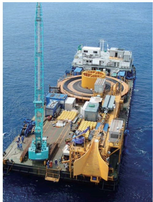
図11 ケーブル布設船「開洋」 Cable installation barge "KAIYO".
