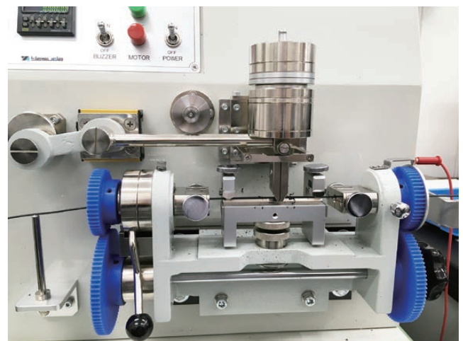
図3 スクレープ摩耗試験機 The scrape testing machine for wear resistance.
