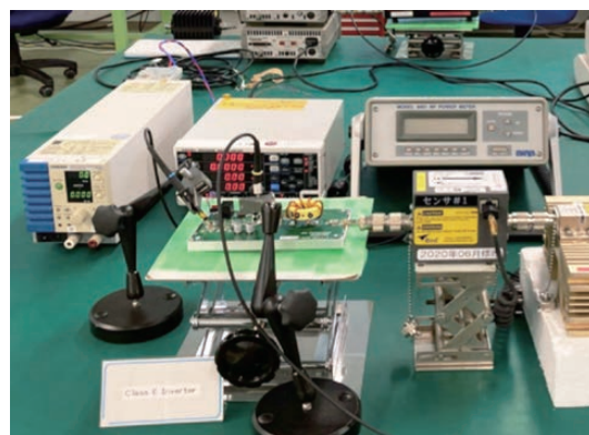
図6 開発したE級インバータ (サイズ: 145 × 80 × 25 mm) The developed class-E inverter.
