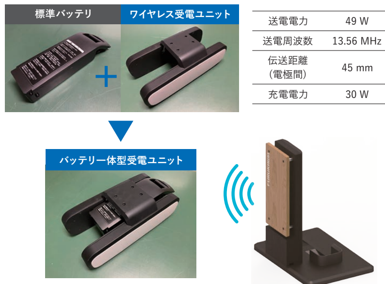
図3 バッテリー一体型受電ユニットと電力伝送性能 Battery-embedded receiver unit and power transfer performance.
